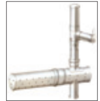
雨水浸透装置
