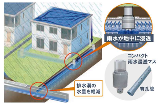
台風・豪雨による浸水被害からまちを守る コンパクト雨水浸透マス・有孔管
