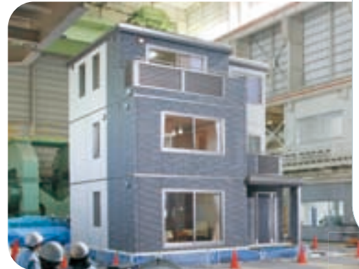
耐震実証実験
