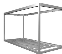
鉄骨系「セキスイハイム」のボックスラーメン構造
